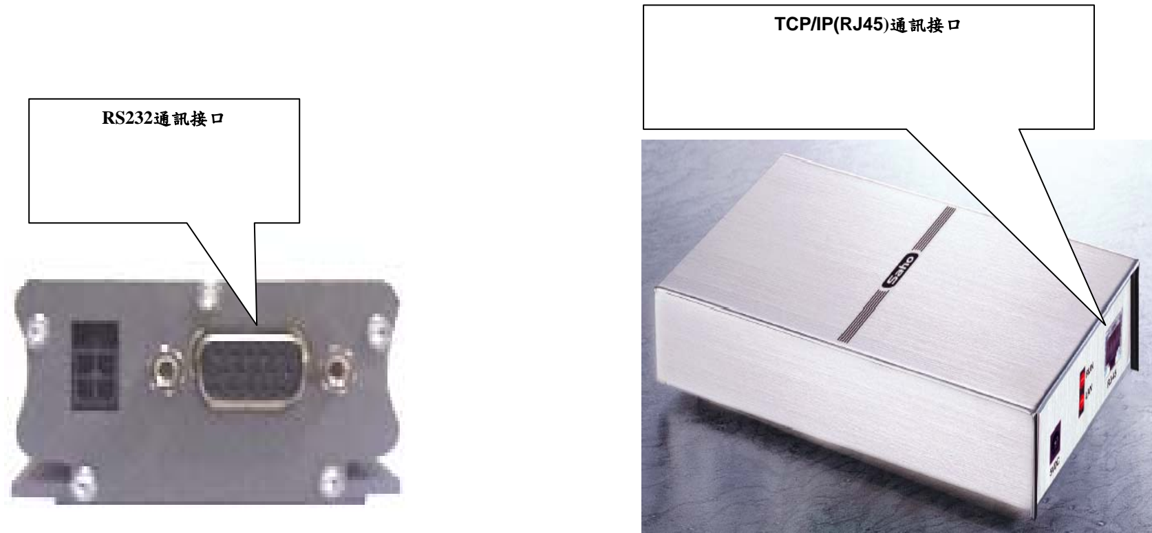
圖6-4-1 弱電設備之RS232與TCP/IP(RJ45)通訊轉換介面圖 (資料來源：本研究整理)
